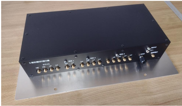
3測定機切り替え機
